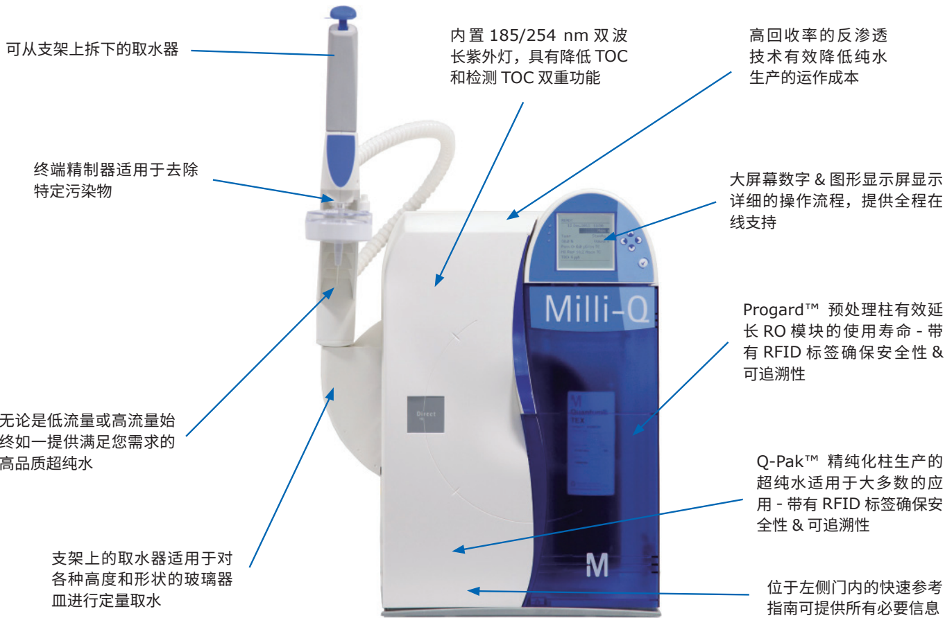
Milli-Q™ Direct 系统内部原理图
