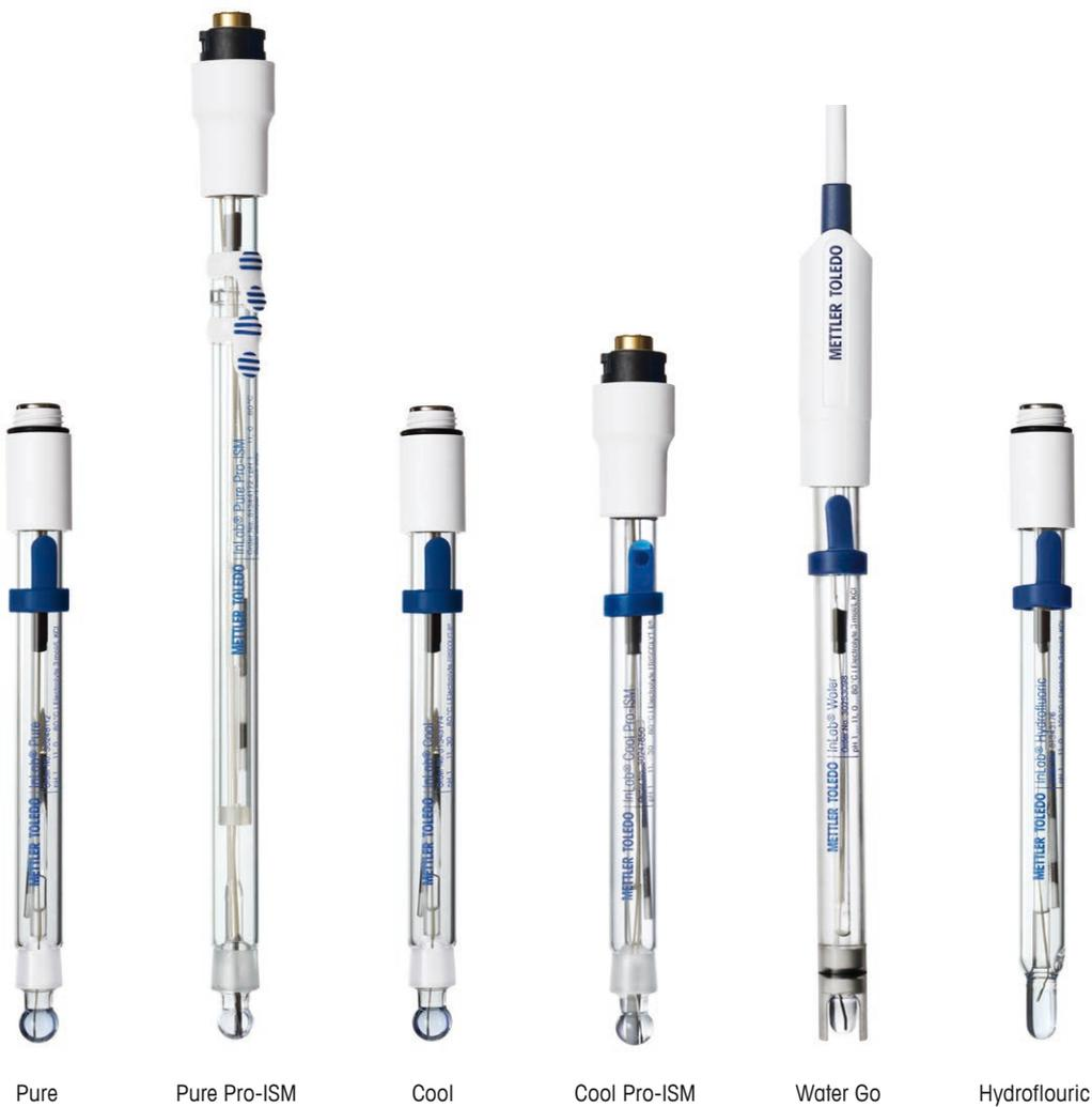
纯水是每个药品生产过程中的关键成分。InLab Pure Pro-ISM 在低离子强度样品中具有卓越的性能。
