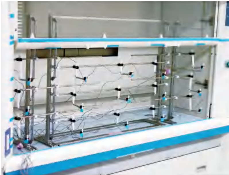
多点风速计的风速测定
